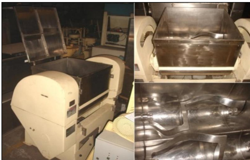
Figura 3.5-10 - Misturador tipo Sigma em aço inox com 2 eixos misturadores com tombamento pneumático
